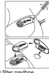
**Poznámka:** Vzduchový filter neumývajte ani nečistite. Ak vzduchový filter navlhne, vymenite ho. Navlhnutý vzduchový filter môže spôsobiť nepriepustnosť.
